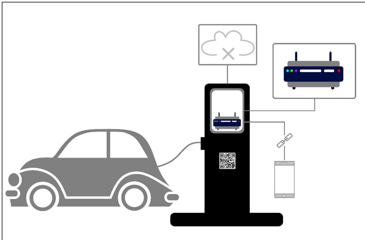
Nachdem alle relevanten Daten eingegeben, und die Zahlung positiv bestätigt wurde, wird eine Verbindung zwischen Smartphone und Ladesäule hergestellt.
